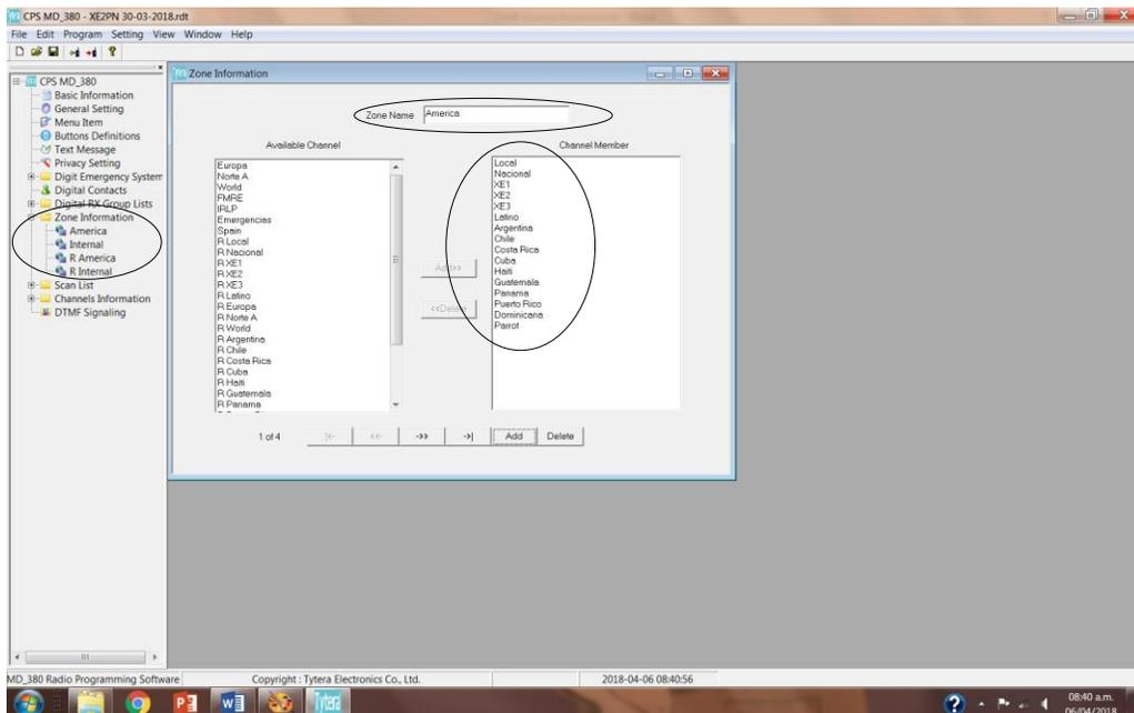
En este ejemplo, se ha creado la Zona “America” que contendrá los 16 Canales enlistados en el campo *Channel Member*. Cada una de las Zonas creadas puede seleccionarse utilizando el Menú del propio equipo; o también, mediante uno de los botones laterales (Side Button) del radio, si se declaró esta opción al configurar *Button Definitions*.
